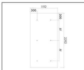
Схема установки пружинных анкеров для панели 2392 x 1192
