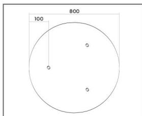
Схема установки пружинных анкеров для панели Ø 800
