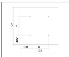
Схема установки пружинных анкеров для панели 1192 x 1192
