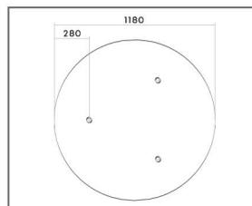
Схема установки пружинных анкеров для панели Ø 1180
